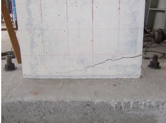
(d) Fracture at the base (0.69% drift ratio)
