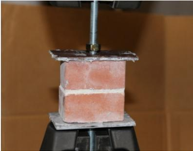
(d) Setup of bond test
