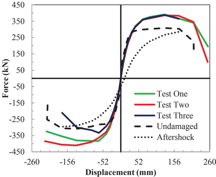
**Figure 3.5.** Force-displacement envelopes
