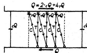
Fig. 16 IDEALIZED TRUSS MODEL OF SERIES-PCW
