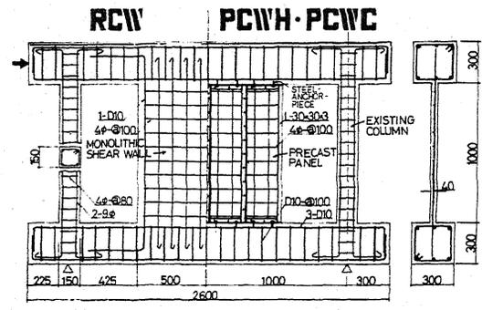
Fig.4 SPECIMEN OF SERIES-PCW
