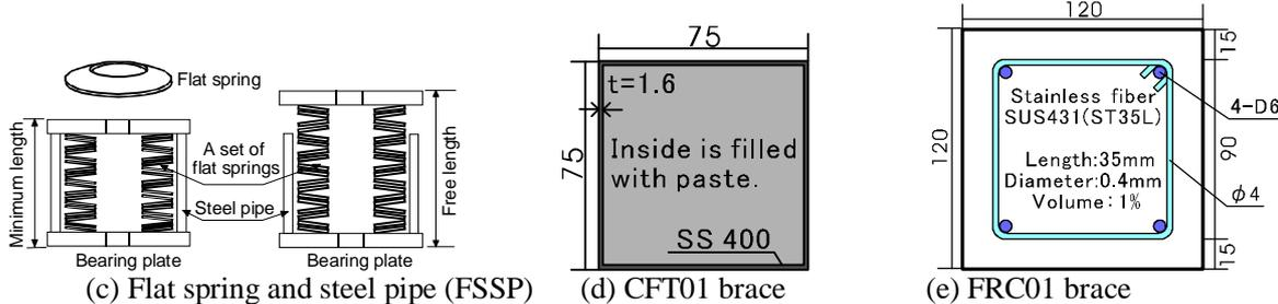
(c) Flat spring and steel pipe (FSSP) (d) CFT01 brace (e) FRC01 brace
