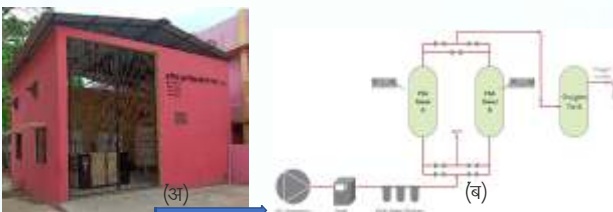
चित्र- 3 (अ) उर्सला अस्पताल कानपुर में स्थापित पी.एस.ए. आक्सीजन उत्पादक संयंत्र एवं (ब) प्रक्रम के प्रमुख अंग
