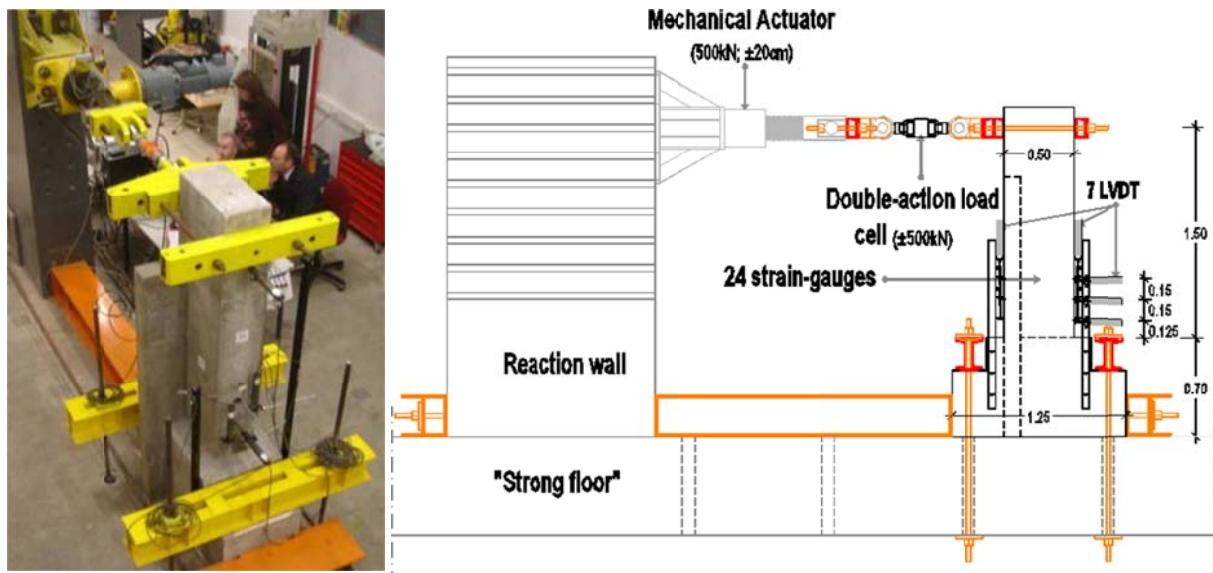
**Figure 3.4.** Test setup
