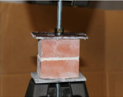
(d) Setup of bond test
