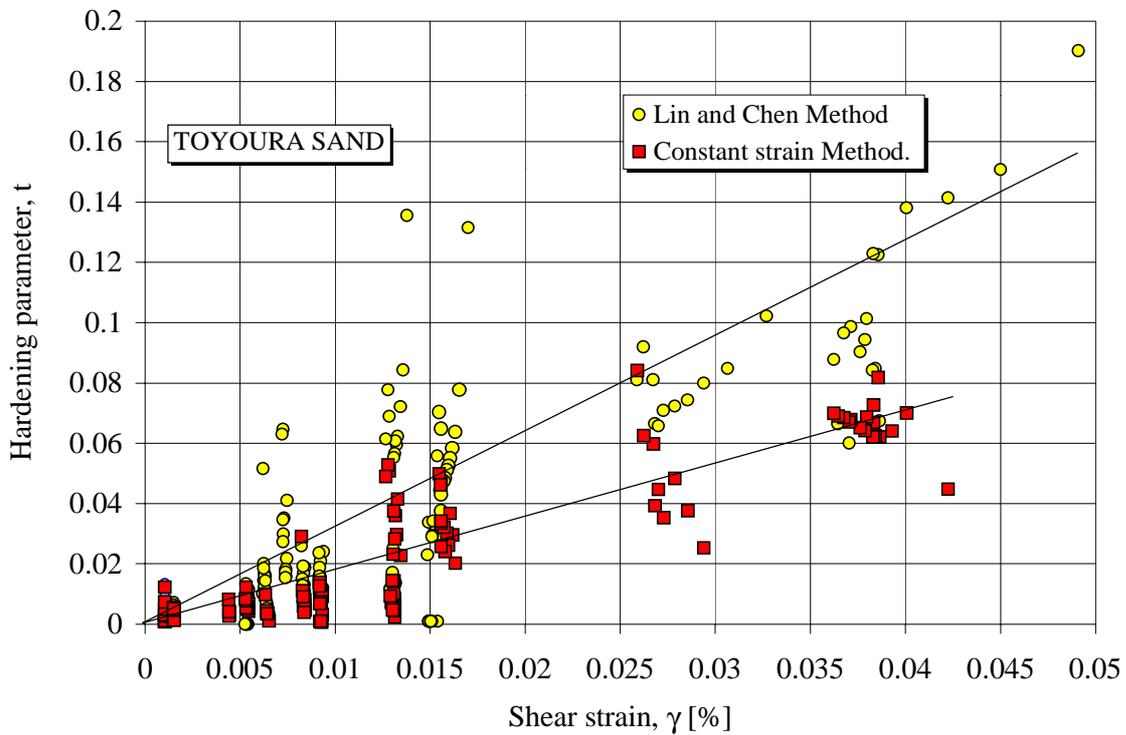
Figure 7. Hardening parameter  $t$  of Toyoura sand.
