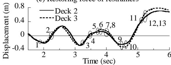
(d) Response displacement of Decks 2 and 3 ( $u_2$  and  $u_3$ )
